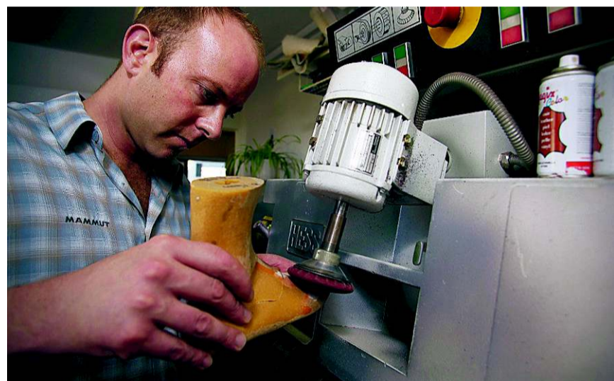
Thomas Huber bei der Herstellung des Gipsmodells für einen Schuh.
